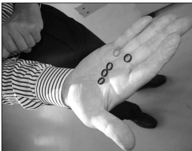
**Herr der Ringe:** Für jedes noch so kleine Detail eines Steckers hat WBT eigene Fertigungsmaschinen. Die Anforderungen sind denkbar hoch: von extremen Hitze-graden und anschließender Abkühlung dürfen sich solche Spezialwerkzeuge nicht beeindrucken lassen. Auch ist der Einspritzdruck zum Teil enorm. Die Präzision in der Fertigung darf bis zu den ersten 700.000 Stück nicht abweichen. Danach geht es in den Überholungservice. (links und oben)
